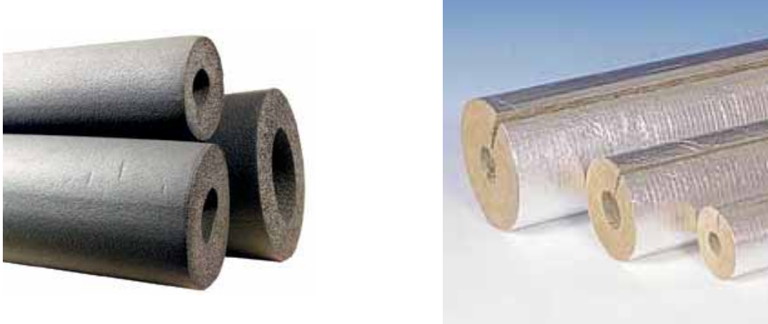
Joonis 10.10 Polüetüleenist koorikisolatsioon (vasakul) on väikese soojustakistusega ja ei ole hea küttetorude soojustamiseks. Küttetorude ja sooja tarbevee torude soojustamiseks sobivad mineraalvillast soojustuskoorikud (paremal).
